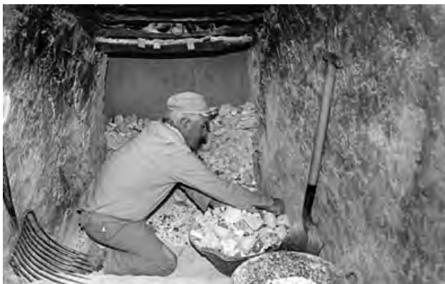
El calciner destria la pedra cuita (Autor de la foto: Josep Bolo Gràcia, ca. 1991).
