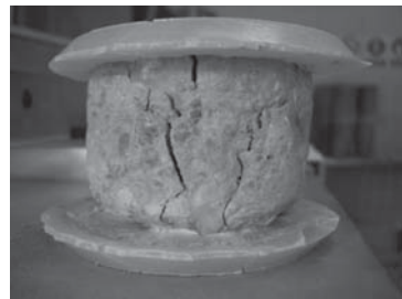
Trencament testimoni de formigó
