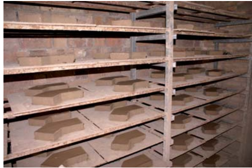
Peces aplantillades de cantonada a l'assegador
